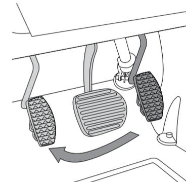
**Spostamento a sinistra del pedale dell'acceleratore**
